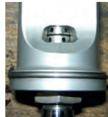
Doppelt einstellbare Einrohrbauweise
